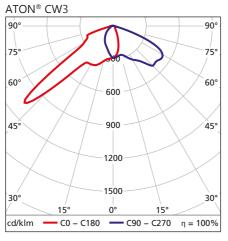
Die speziell entwickelte Cross Walk-Optik ermöglicht eine optimale Ausleuchtung von Fußgängerüberwegen.
